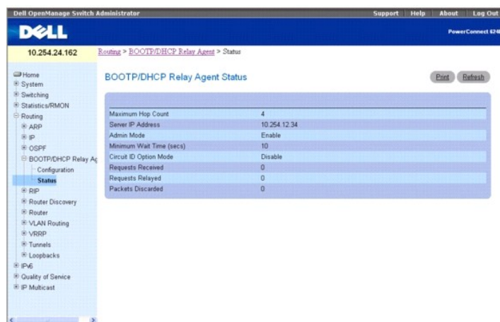
Figure 10-22. Page BOOTP/DHCP Relay Agent Status (État de l'agent de relais BOOTP/DHCP)
