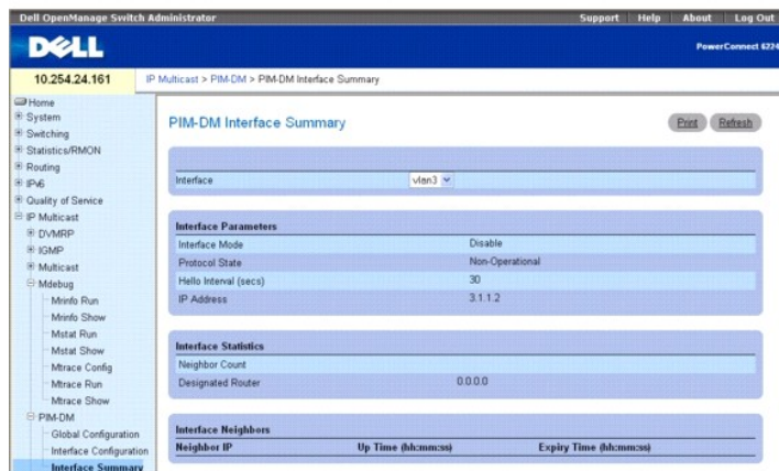
Figure 13-25. PIM-DM Interface Summary (Récapitulatif des interfaces PIM-DM)
